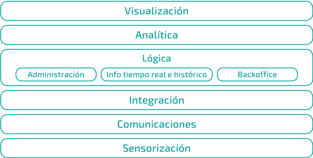
Ilustración 2: Stack tecnológico para trazabilidad basado en arquitectura IoT
